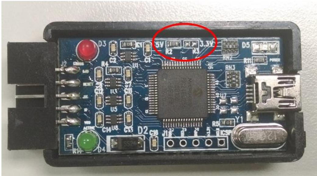
拆开 MQLink 外壳，对 R2 或 R3 焊 0 欧姆电阻，可设置 MQLink 讯号电压为 5V 或 3.3V
