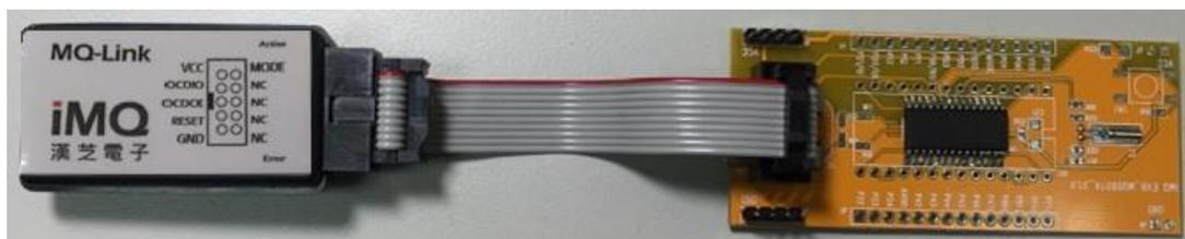
图 2.5 MQ-Link 与 EV Board 连接的示意图 (EV Board 上有产品芯片)
